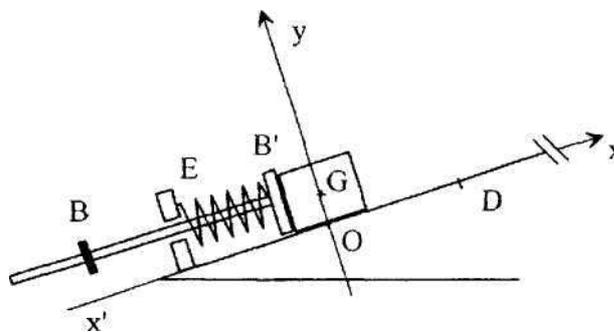
Un manipulateur tire sur la tige et comprime ainsi le ressort jusqu'à ce que le centre d'inertie du palet se trouve au point O. En lâchant la tige, il libère le dispositif qui propulse le palet.
